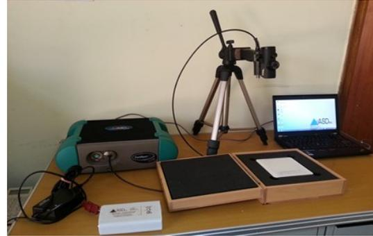
شكل (1) جهاز السبكتروراديوميتر FieldSpec
