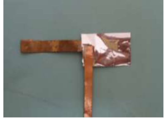
الشكل (6) صورة فوتوغرافية لمادة الـ (PVDF) البوليمرية بعد لصق الاقطاب النحاسية عليها.
