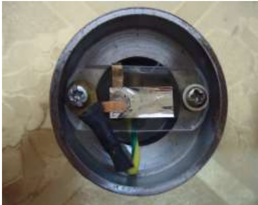
الشكل (9) يبين الحافظة المعدنية بعد ان وضع بداخلها مادة الـ PVDF البوليمرية والدائرة الكهربائية المرتبطة بها.
