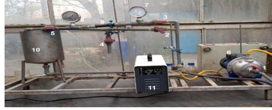
شكل (3) منظومة مختبرية مكونة من: (1, 2, 3, 4 و 5) صمامات تحكم، 6 مضخة ماء، (8,7) مقاييس ضغط، 9 جهاز venture 10، خزان التجميع، 11 جهاز توليد الأوزون.
