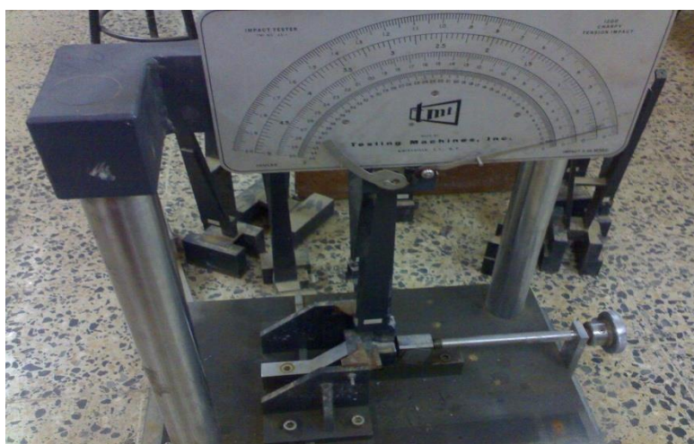
الشكل (1) يوضح جهاز اختبار الصدمه بطريقة جاري.
