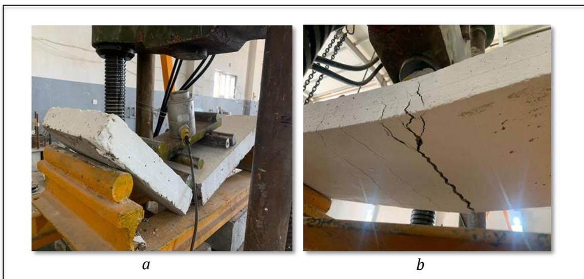
**Fig. 4 Slab Test**
