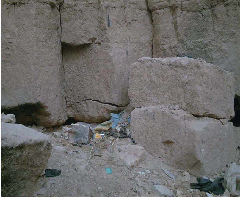
شكل (4): صورة لمقطع عمودي في تكوين انجانة يوضح وجود بعض الفواصل لم تحصل عليها ازالة قرب مدينة النجف الاشرف
