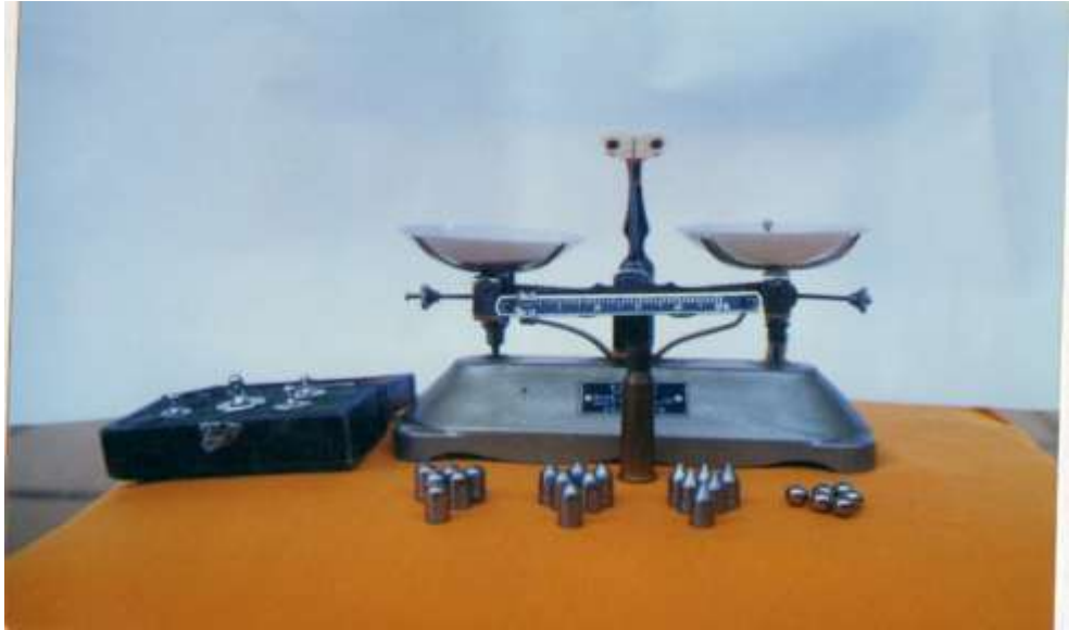
الشكل (8) يوضح القذائف المستخدمة في البحث مع جهاز وزن استخدم لوزن حشوة القذيفة للتحكم بسرعة القذيفة
