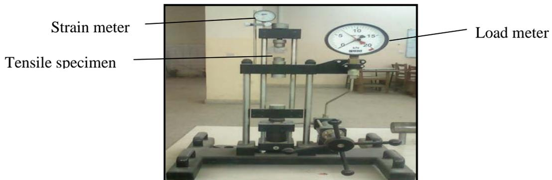
Figure (2) Tensile Test Device
