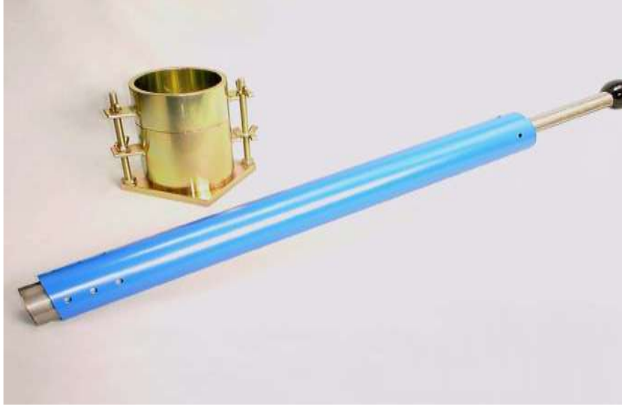
الشكل (٢): القالب القياسي لرص التربة مختبريا.
