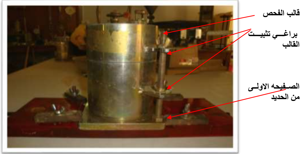
الشكل (8) : طريقة تثبيت قالب الرص القياسي على قاعدة الجهاز.
