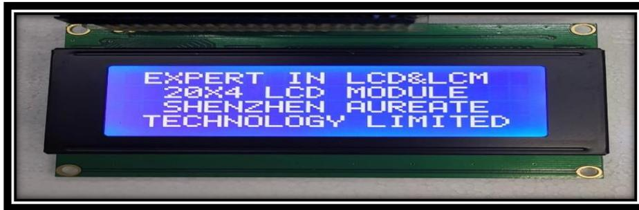
الشكل (8) شاشة LCD 4x20
