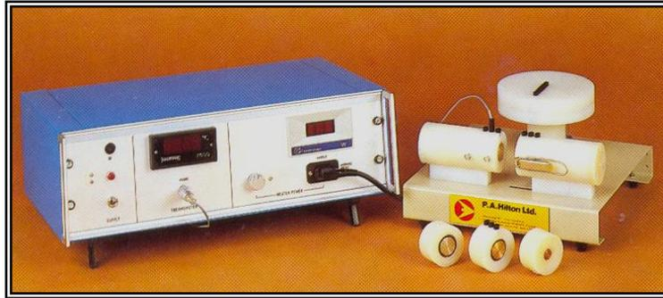
الشكل رقم (3) : جهاز قياس الموصلية الحرارية
