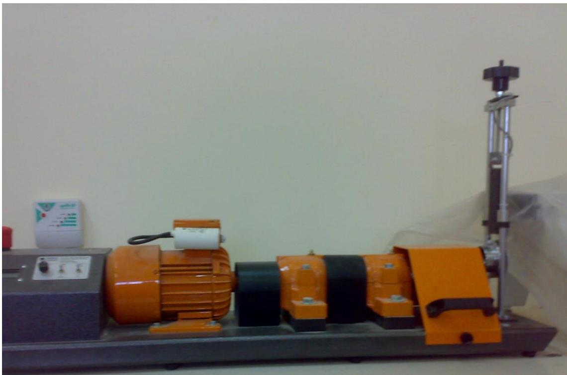
الشكل (2) يوضح جهاز اختبار الكلال بالأنحناء الدوار (Rotary Bending) المستخدم في البحث
