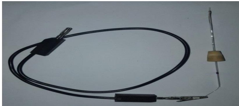
الشكل (٢) يمثل صورة للمجس المستخدم لدراسة التفريغ الكهربائي
