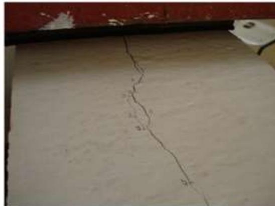
(d) Longitudinal cracks at left side, top surface.
