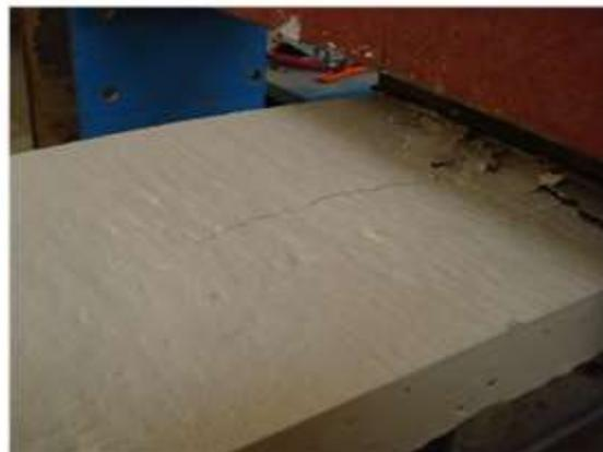
(d) Longitudinal cracks at right side & concrete crushing at max. +ve
