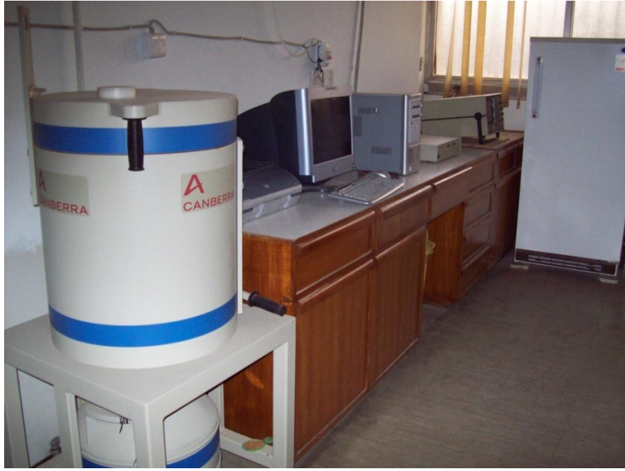
شكل 2. يبين منظومة تحليل أطياف أشعة كاما.
