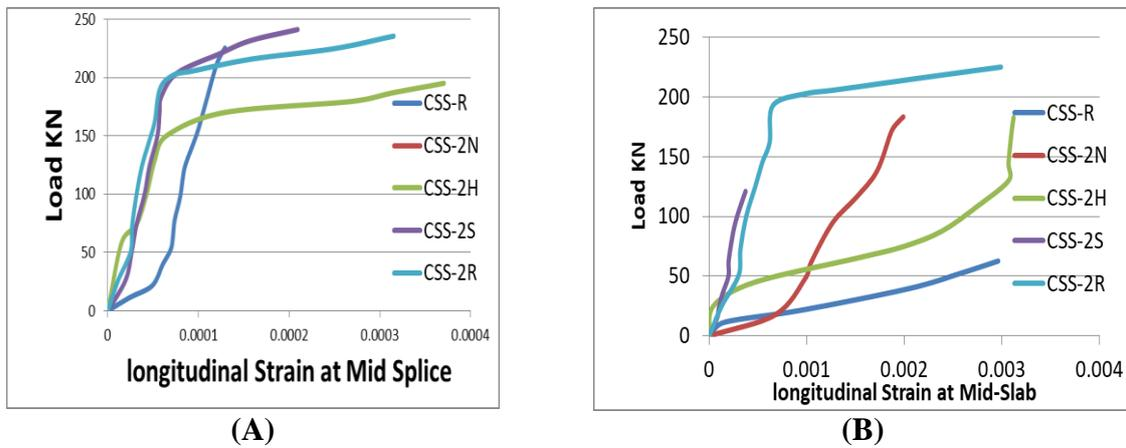
**Figure 11 Longitudinal concrete strain at: A) Mid splice and B) Mid slab.**
