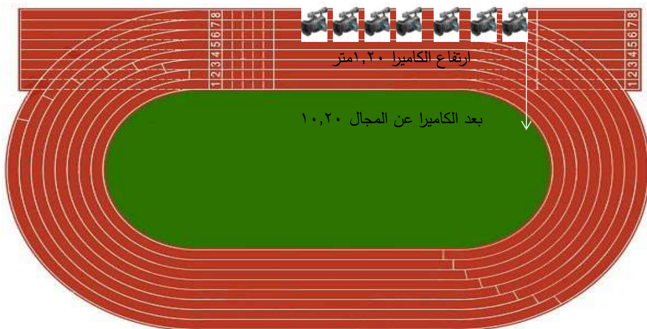
الشكل (١) يوضح كيفية وضع الكاميرات على مجال الركض في التصوير الفديوي واختبار الإنجاز ركض ١٠٠ متر
