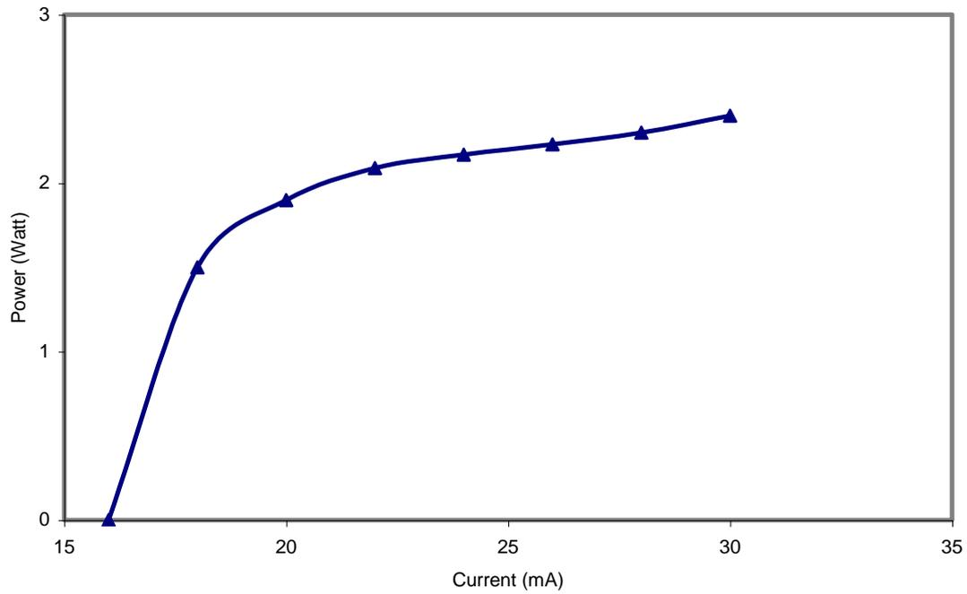
شكل (4) تغير قدرة الخرج الليزري مع تيار التفريغ الكهربائي.
