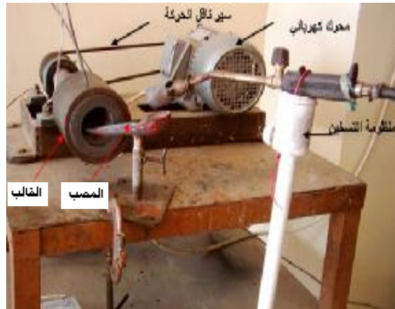
شكل (1) منظومة سباكة الطرد المركزي المصنعة من قبل الباحثين
