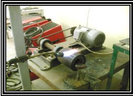
الشكل (4) يوضح عملية تسخين القالب قبل البدء بصب المعدن.
