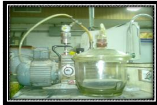
شكل (2) يوضح جهاز قياس المسامية المستخدم.
