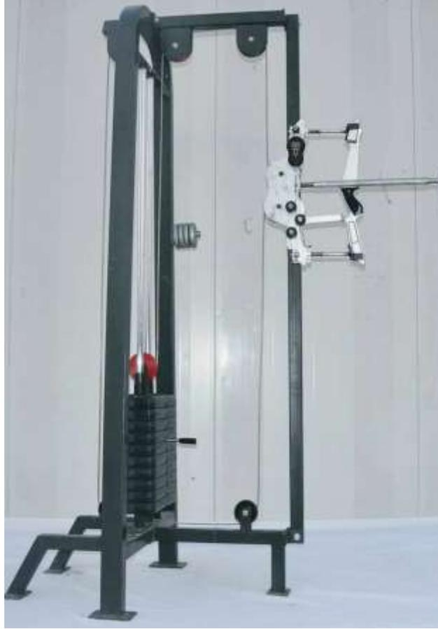
الشكل (٢) يوضح جهاز قياس قوة الدفع
