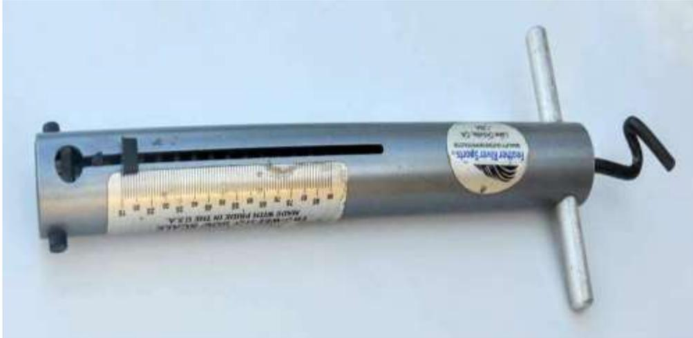
الشكل (١) يوضح جهاز قياس قوة الشد (السحب)
