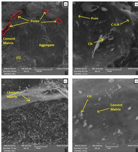
Figure 7. The SEM micrographs (a) & (b) CON mix, (c) & (d) 2.0 AL mix
