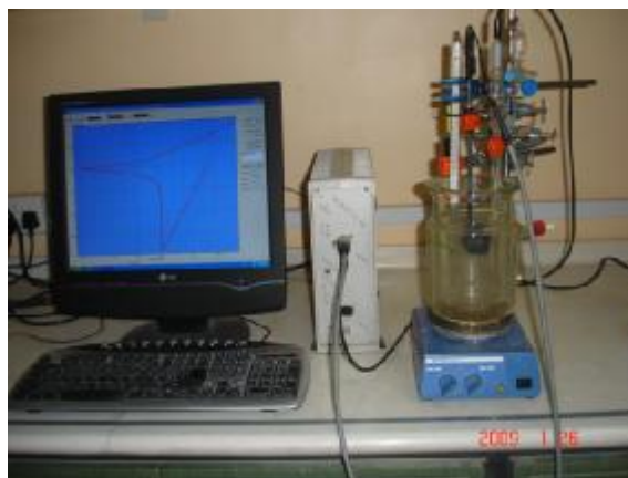
الشكل ( 1 ) جهاز اختبار التآكل بالطريقة الكهروكيميائية .
