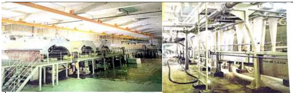
صورة رقم (٨) وحدة التبييض تتم فيها عملية قصر العجينة لتحويلها من اللون الأسمر إلى الأبيض
