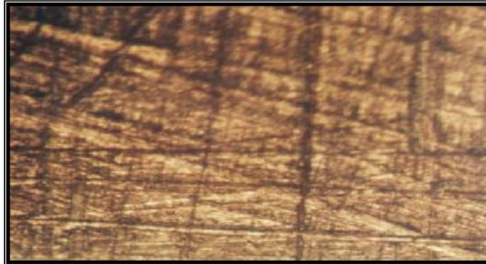
شكل (a) السبيكة الأساس التي بدون معاملة كيميائية
