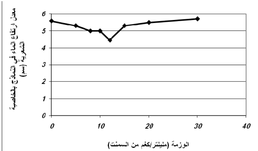
شكل (4)- تأثير محتوى المضاف المانع لنفاذ الماء على الامتصاص بالخاصية الشعرية لخلطات ذات قابلية تشغيل ثابتة هطولها (5 \pm 50) مم.
