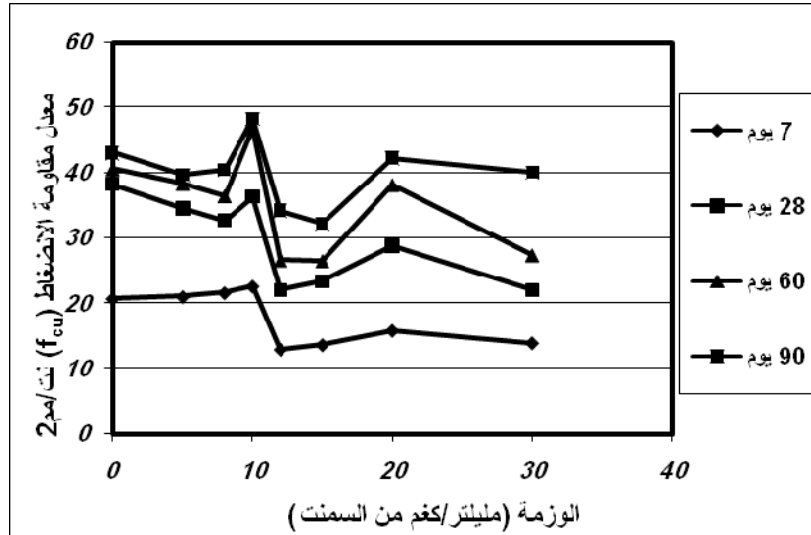
شكل (2)- تأثير محتوى المضاف المانع لنفاذ الماء على مقاومة الانضغاط لخلطات ذات قابلية تشغيل ثابتة هطولها (5 \pm 50) مم.
