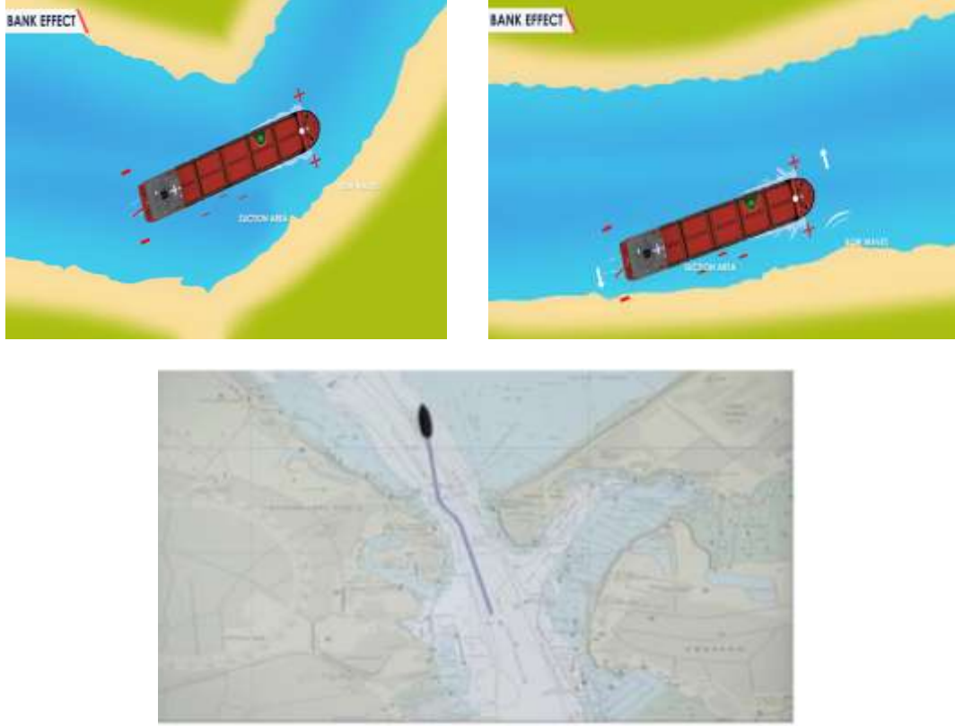
الشكل (١٠) مخطط لمراحل جنوح السفن بسبب تأثيرات القوى المؤثرة والضفة الساحلية في توازن السفينة عند الابحار في ممرات ضيقة. عن (Fotedar, 2021)
