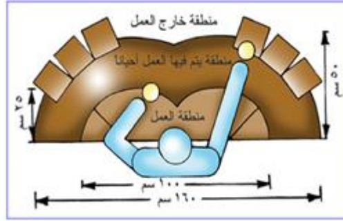
شكل (٣) يوضح المساحة السطحية لطاولت العمل ومقاساتها
