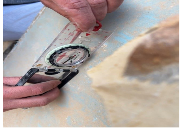
صورة رقم (5): قياس زاوية الاحتكاك الداخلي في المختبر بطريقة الإمالة (Bieniawski, 1989)
