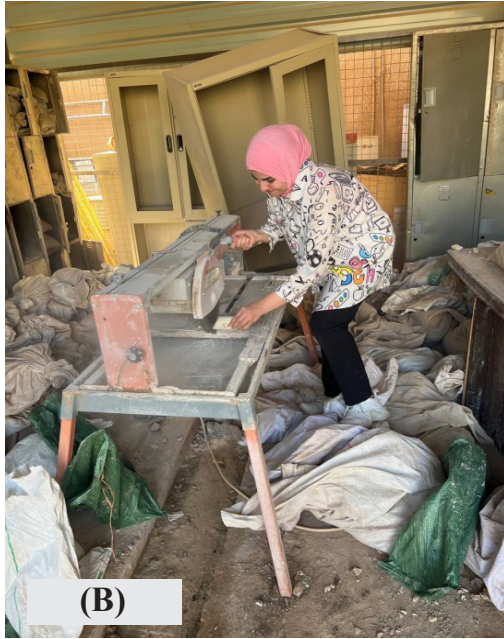
صورة رقم (4): (A) تهييب اللباب من خلال آلة قطع الصخور ، (B) تثبيت النماذج في آلة قطع اللباب
