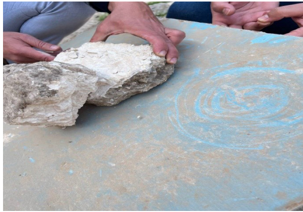
صورة رقم (5): قياس زاوية الاحتكاك الداخلي في المختبر بطريقة الإمالة (Bieniawski, 1989)
