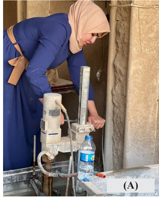
صورة رقم (4): (A) تهييب اللباب من خلال آلة قطع الصخور ، (B) تثبيت النماذج في آلة قطع اللباب
