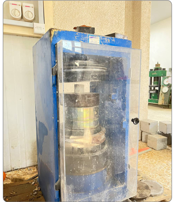
لوحة (2) وضع النموذج في جهاز فحص المقاومة الانضغاطية
