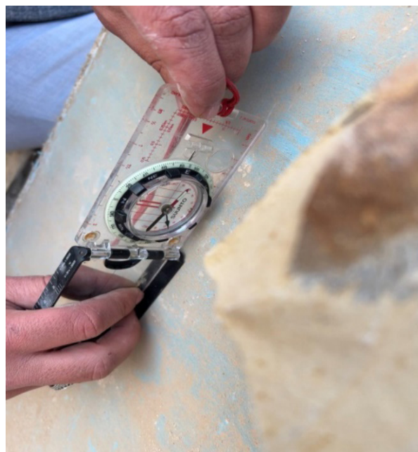
لوحه رقم (4) قياس زاوية الاحتكاك الداخلي
