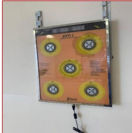
الشكل (3) يوضح جهاز قياس سرعة رد الفعل
