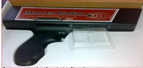
الشكل (4) يوضح جهاز الرادار لقياس سرعة الكرة
