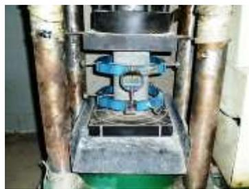
(d) Static modulus of elasticity
