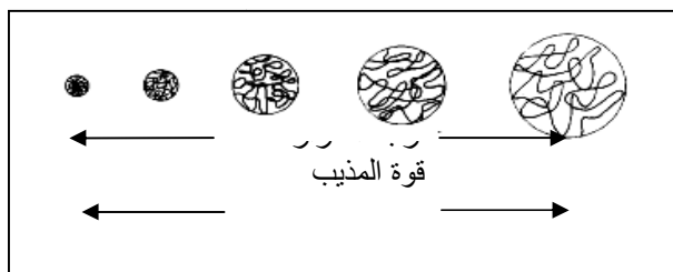
شكل (2) توسع جزيئات البوليمر بفعل الحرارة [15].
