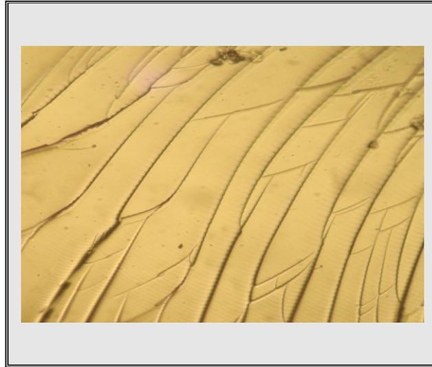
الشكل (14) الفحص المجهرى للأساس المدعم بمسحوق (SiO2) وبال حجم الحبيبي (50µm) يوضح استواء
