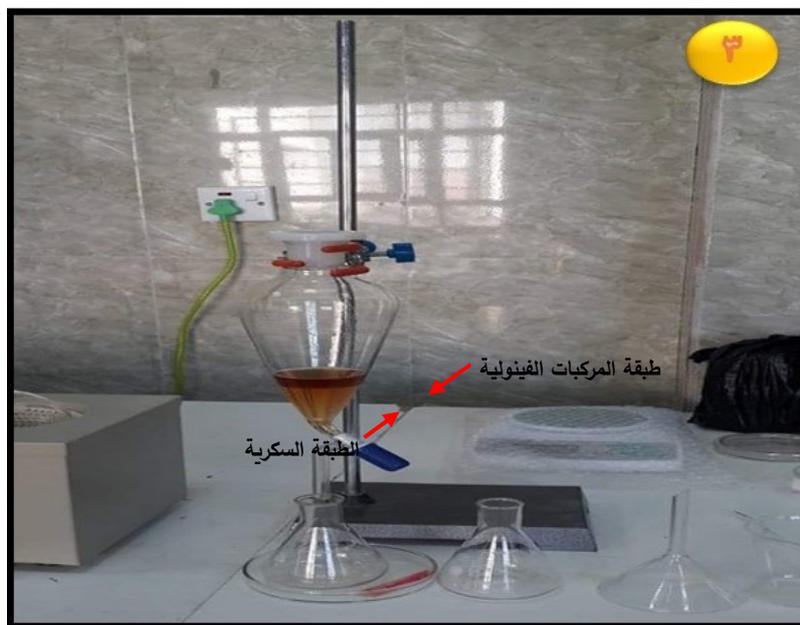
الصورة (٣): عملية التحلل الحامضي في مختبر الكيمياء للكلية التقنية الزراعية.
