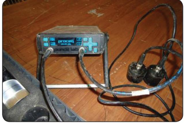
شكل (2): الجهاز المستخدم لقياس سرعة الأمواج فوق الصوتية
