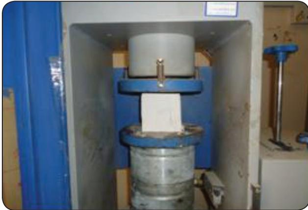
شكل (4): فحص مقاومة الانضغاط لمكعبات الترمستون
