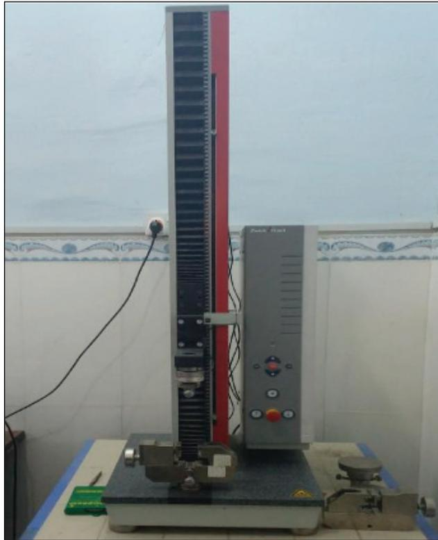
الشكل رقم (3): يوضح صورة فوتوغرافية تبين جهاز قياس بعض الخواص الميكانيكية (Tensile).
