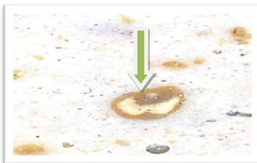
الشكل 4: الفحص المجهرى لمقطع من سطح المادة الاساس المدعمة بمسحوق مادة (Kaolin) وبنسبة (1.5 gm) (X400)
