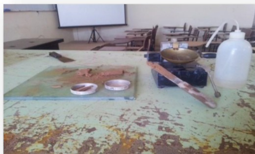
Fig. 5. Apparatus of (L.L&P.L).
