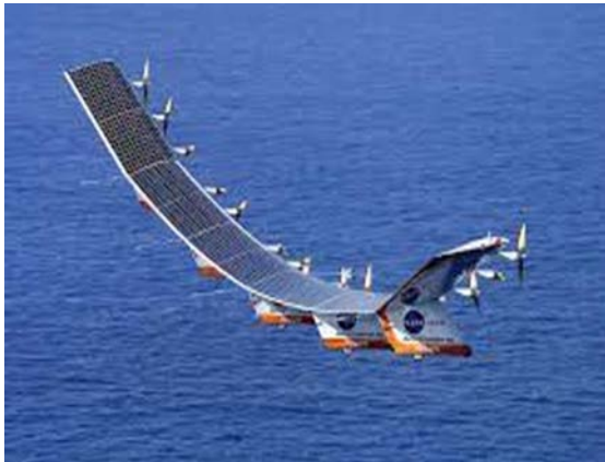
شكل (٢) نموذج لطائرة تحصل على الطاقة الكهربائية من الشمس
