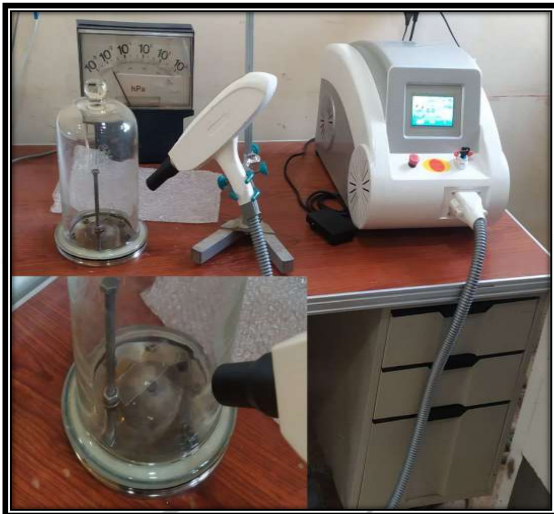
الشكل (٤) مخطط لحجرة الترسيب و جهاز الليزر المستخدم في ترسيب الأغشية.
