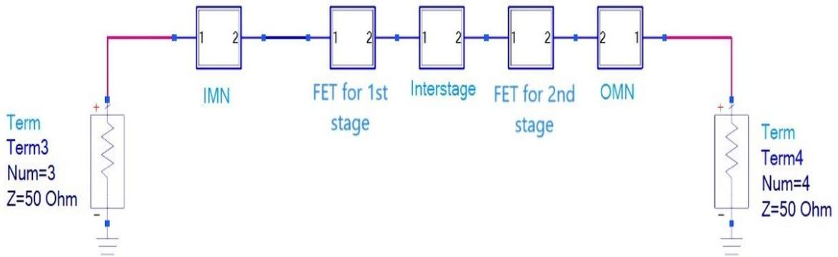
Figure 10. Circuit Diagram of a Multi-Stage LNA
