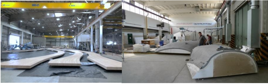
شكل (3-3) الية عمل قوالب الـ GRC والـ GRG المصممة بارامترياً المصدر:
