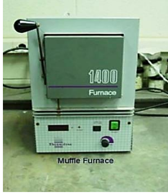
الشكل (١): طريقة الاحتراق الجاف لاحتساب النسبة المئوية للمواد العضوية في التربة
