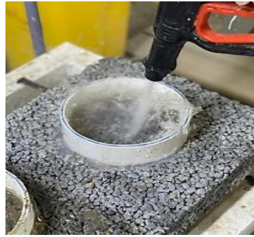
الشكل (١٨): استخدام ماكينة غسل المركبات لفتح المسامات
