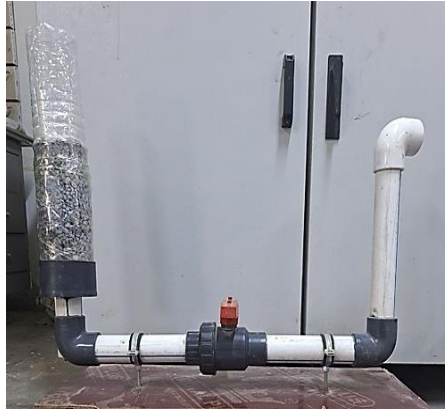
الشكل (١٠): جهاز فحص نفاذية الخرسانة المسامية بطريقة Constant head
