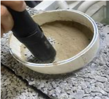
الشكل (١٩): استخدام المكنسة الكهربائية لشطف الغبار من المسامات
