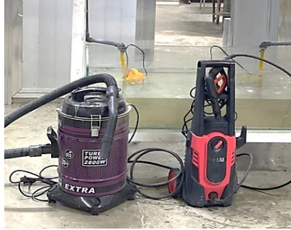
الشكل (١٢): الأجهزة المنزلية المستخدمة في تنظيف مسامات خرسانة الرصف المسامية
