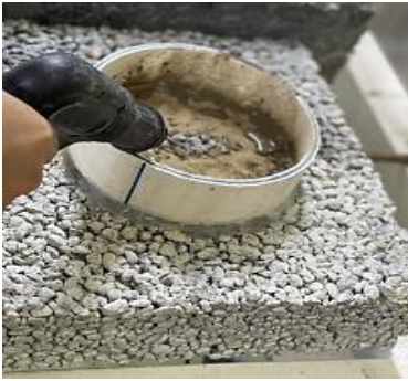
الشكل (١٨): استخدام ماكينة غسل المركبات لفتح المسامات
