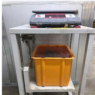
الشكل (١١) : قياس وزن نموذج مغمور من الخرسانة المسامية
