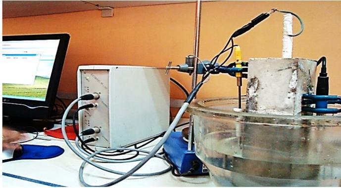
شكل رقم (٣): جهاز قياس تيار التآكل لحديد التسليح
