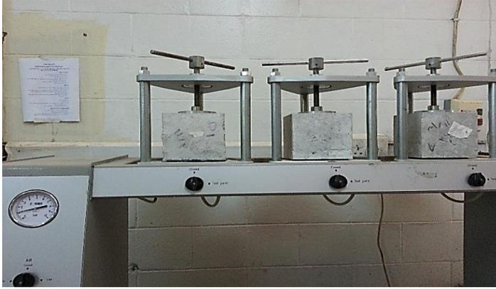
شكل رقم (٢): جهاز فحص النفاذية تحت ضغط الماء
