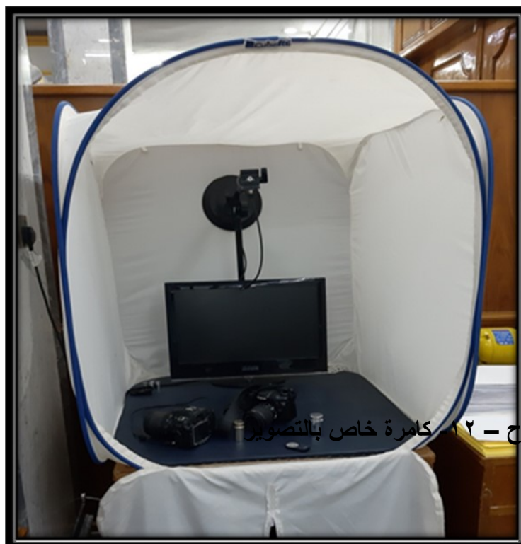
لوح - ١١ - جهاز التصوير الخاص بالمخطوطات والوثائق
