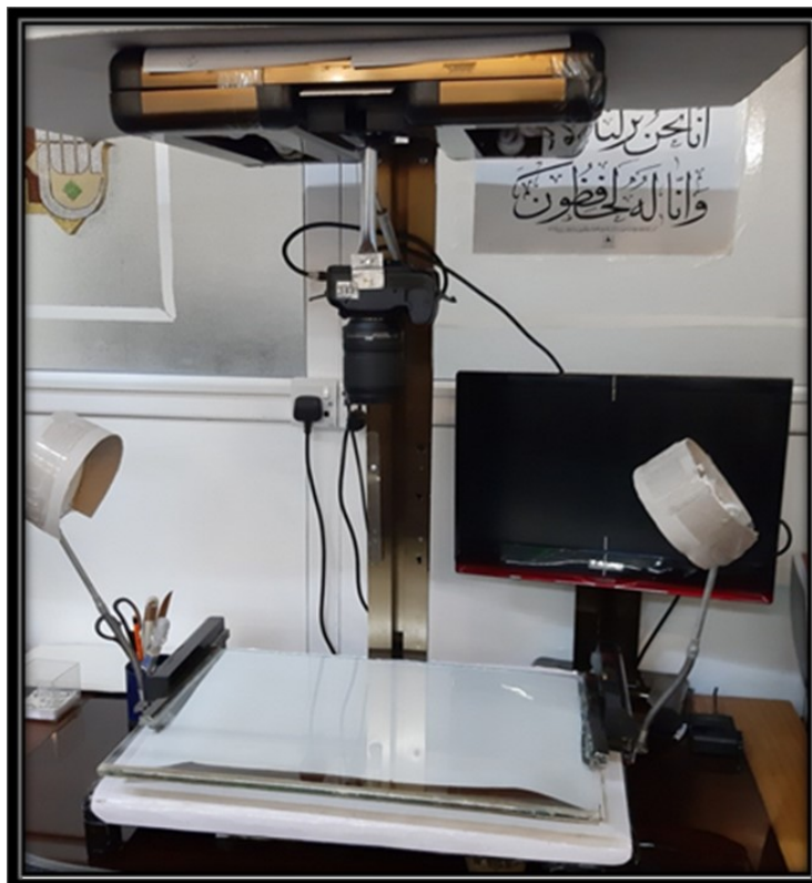
لوح - ١١ - جهاز التصوير الخاص بالمخطوطات والوثائق
