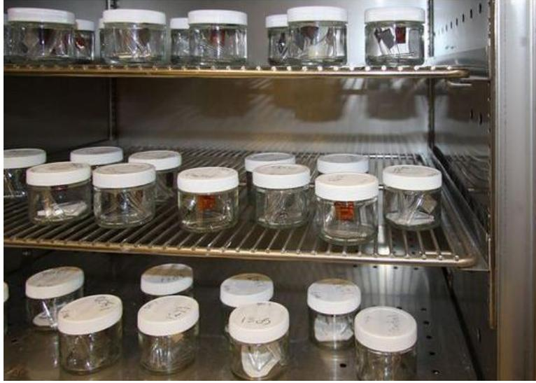
صورة توضح اختبار Oddy للغازات الضارة<sup>٣٨</sup>
