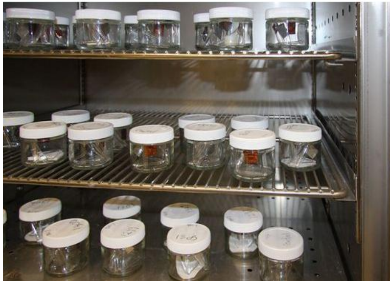
صورة توضح اختبار Oddy للغازات الضارة ٣٨
