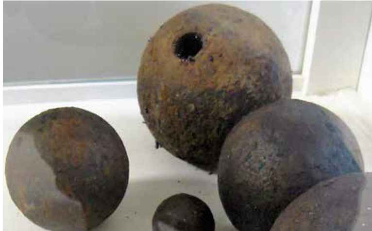
كرات مدفعية تعاني من الصدأ والتآكل بسبب الرطوبة النسبية العالية ١٤
