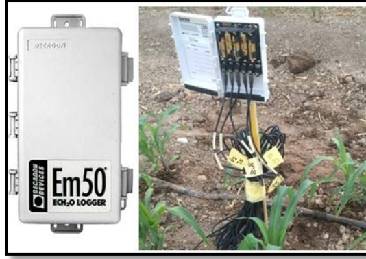
شكل 3. مسجل البيانات Data Logger نوع Em50
