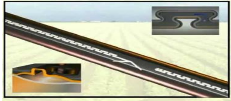
شكل 1. انابيب الري بالتنقيط تحت السطحي الشريطية نوع Ro-Drip-Drip Tape كما يظهر الشكل المنقطات الناضحة لماء الري
